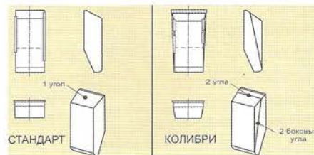
Рис. 3. Различия между стандартным зубом и зубом типа «КОЛИБРИ»
