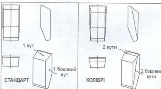
Рис. 2. Різниця між стандартним зубом та КОЛІБРИ.
